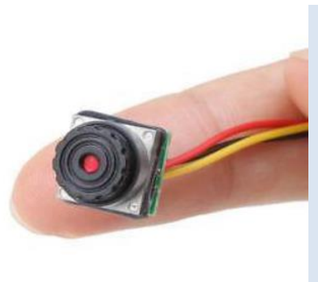
Камера – за снимање уноса PIN-а (поставља се у одговарајућу позицију за снимање нумеричке тастатуре)
