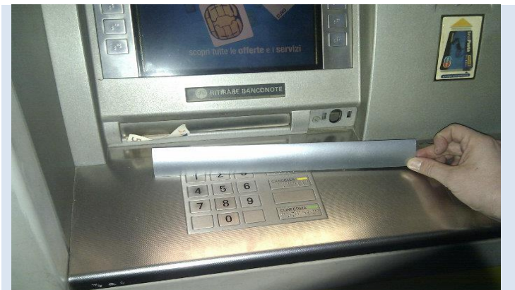
Cash trapping - уређај задржава новчанице (поставља се на отвору за исплату новца)
