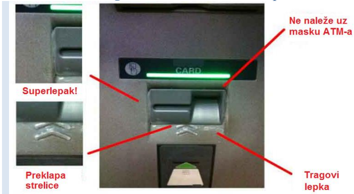
Skimming device - лажни читач картица
